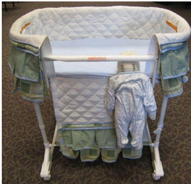
この布製フラップを調整した際に、ベルクロが正しく再固定されなかった場合、開口部から乳児が滑り落ちて金属バーの間に挟まり、窒息するおそれがあった。
